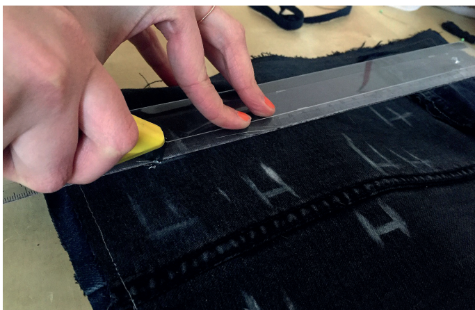
17. Kobercovým řezákem prořízneme obě vrstvy látky.
