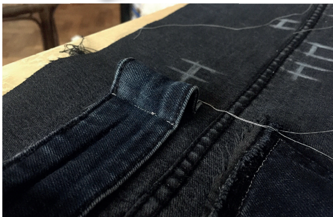
13. ...a dalším šitím upravíme přesný rozměr (např. pro tlustší fix).
