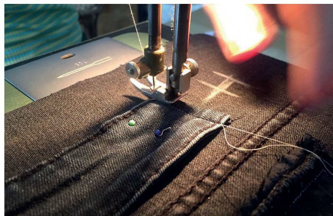
12. Zástrčku na větší tužky (silnější proužek džínoviny) nejprve přišijeme na jednom konci...
